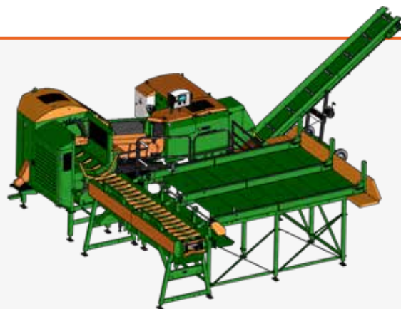
SpaltFix K-700 Vario avec plate-forme (côté opérateur) et système de transport de troncs
